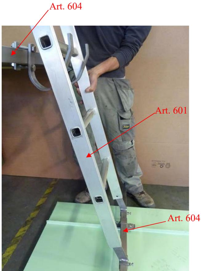
2.) Eingehängte Leiter. Die Leiter muss so gekürzt werden dass die Leiterstufe in den Haken aufliegt ohne das die Leiterholme auf der Leiterbasis aufliegen. Die Leiter muss 15° Neigung zur vertikalen aufweisen
